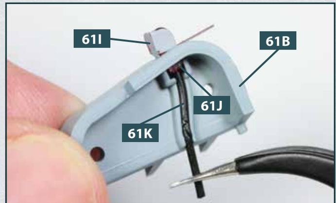
**4** Fügen Sie die rote Lichtabdeckung **61J** von außen in die Aufnahme der linken Plattform **61B** ein. Die Laterne **61I** bleibt außerhalb der Plattform, der Lichtleiter **61K** wird in die Führung auf der Plattform hineingedrückt.
