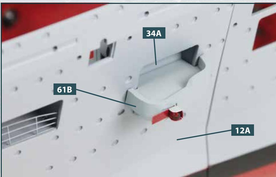
**12** Die linke Plattform **61B** ist am Rumpfteil **12A** befestigt, das Ende des Lichtleiters sitzt in der Bohrung der Halterung **34A**.
