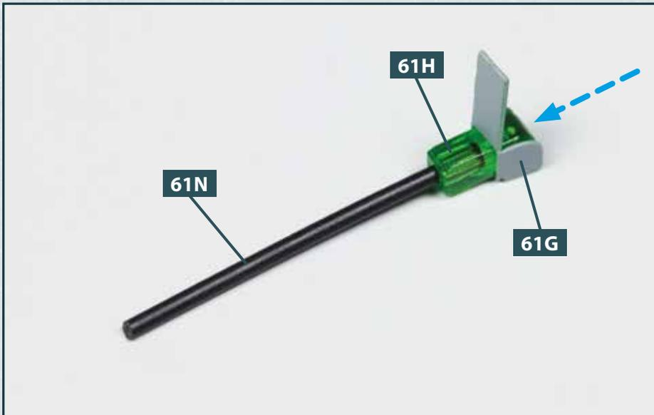
**7** Nun wird die Steuerbord-Seitenlaterne zusammengebaut: Setzen Sie die grüne Lichtabdeckung **61H** in Richtung des gestrichelten Pfeils in die grüne Seitenlaterne **61G** ein. Beide Teile schließen außen annähernd bündig ab. Nehmen Sie den 22 mm langen Lichtleiter **61N** und fügen Sie eins seiner Enden bis zum Anschlag in die Bohrung am inneren Ende der Lichtabdeckung **61H** ein, wie es das Foto zeigt.
