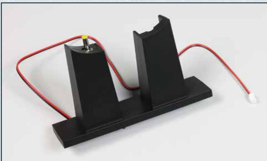
Der Zusammenbau des Ständers hat an der ersten Stütze begonnen, in der ein Kontaktkabel verlegt wurde.
