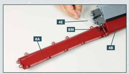
2 Befestigen Sie den Rumpfabschnitt 8A mit einer Sechskantschraube BM am Kielabschnitt 4B. Verwenden Sie zum Eindrehen der Sechskantschraube den Innensechskant 4E.
