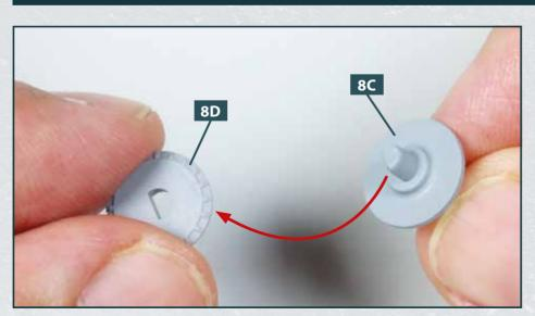
1 Nehmen Sie die Spillwelle **8C** und führen Sie deren Zapfen von unten durch die Bohrung vom Unterteil der Spilltrommel **8D**. Achten Sie dabei auf die Ausrichtung der Spilltrommel.
