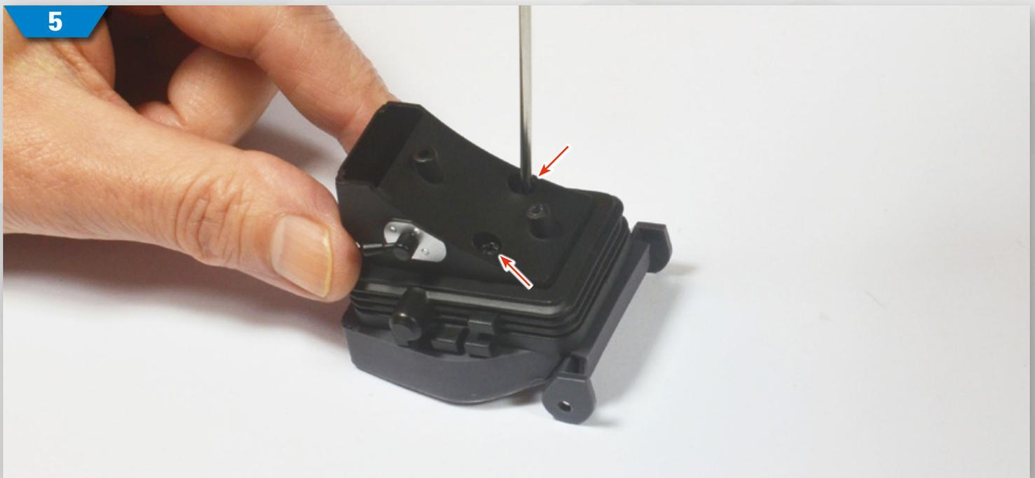
**5** Verbinden Sie die Bauteile miteinander, indem Sie zwei PS05-Schrauben in die gezeigten Löcher eindrehen.
