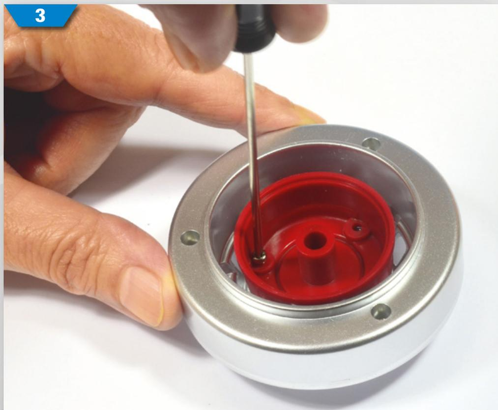
**3** Beginnen Sie mit der Befestigung der Teile, indem Sie eine DS01-Schraube in dem gezeigten Loch in der Radnabe leicht anziehen. Ziehen Sie die Schraube vorerst nicht fest.
