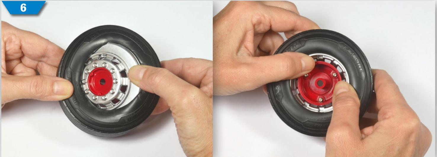
**6** Drehen Sie die Felge im Inneren des Reifens, bis sie komplett im Reifen eingesetzt ist. Wenn Sie fertig sind, sollten die Ränder des Reifens perfekt auf beide Felgenflächen passen.
