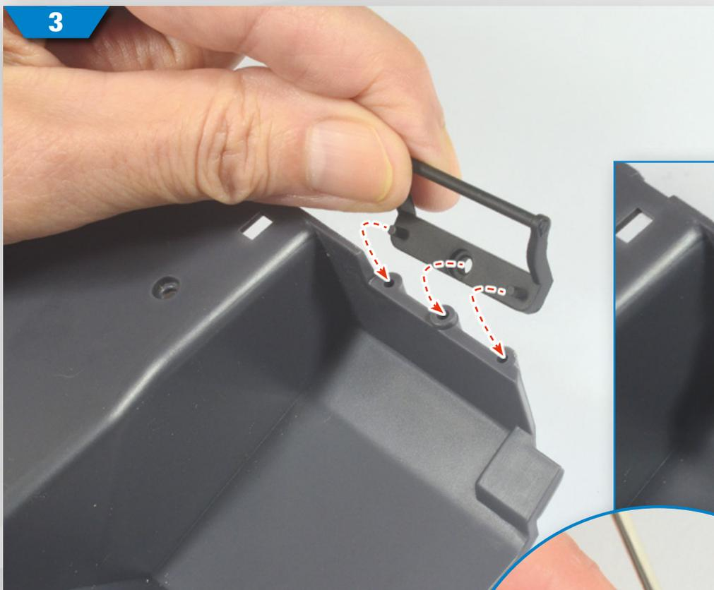
**3** Bringen Sie die Fußstütze des Beifahrers an der dafür vorgesehenen Stelle an der Oberseite des Kabinenbodens an. Richten Sie die Teile wie auf dem Foto gezeigt aus und befestigen Sie die Fußstütze mit einer PS05-Schraube.
