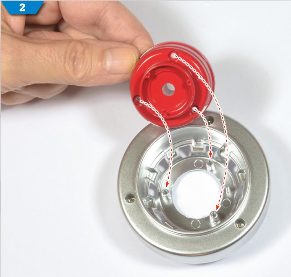
**2** Nehmen Sie jetzt die Felge wieder zur Hand, die Sie in Bauphase 17 zusammengebaut haben. Richten Sie die drei Löcher in der Radnabe auf die gebohrten Zapfen in der Felge aus.
