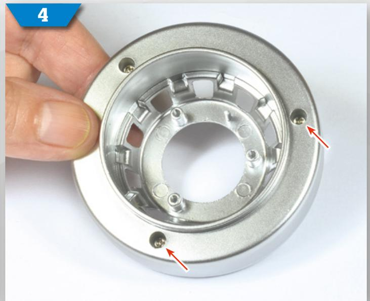
**4** Setzen Sie in jedes der verbleibenden Löcher im inneren Felgenteil eine DS01-Schraube. Ziehen Sie anschließend alle drei Schrauben fest.
