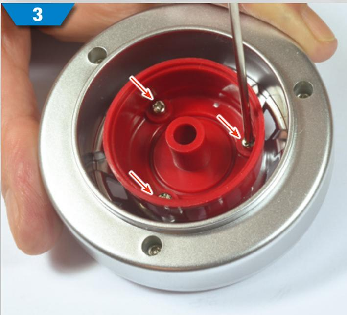
**3** Befestigen Sie die Nabe an der Felge, indem Sie drei DS01-Schrauben in den gezeigten Löchern anziehen.
