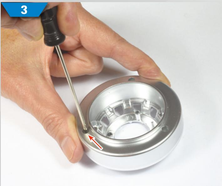
**3** Beginnen Sie mit der Befestigung der beiden Felgenteile, indem Sie eine DS01-Schraube in einem der drei Löcher des inneren Teils leicht anziehen.
