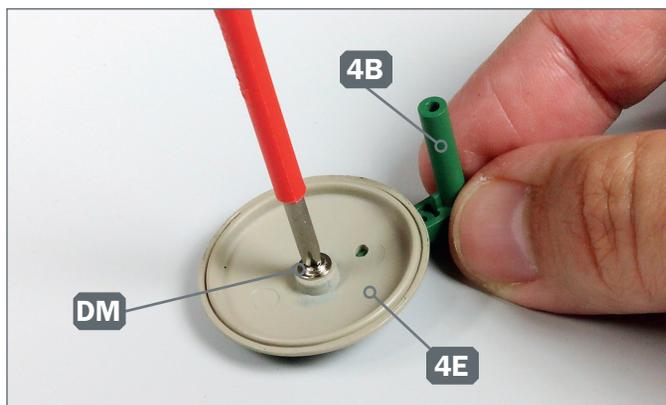
**3** ▶ Befestigen Sie den Arm 4B am Deckel 4E, indem Sie die Schraube DM in die Bohrung des Zapfens eindrehen, wie abgebildet.
