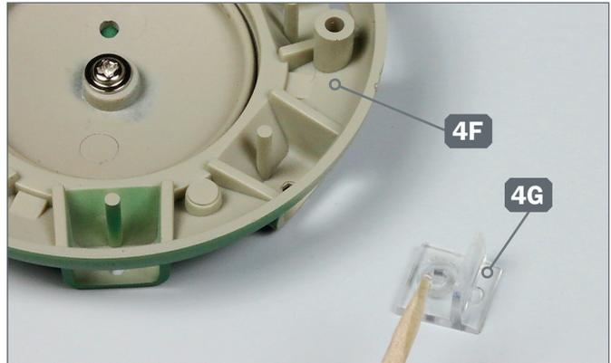
**2 ▶** Drehen Sie den Ring der Kommandantenkuppel 4F um. Legen Sie den ersten Prismenspiegel 4G bereit und versehen Sie seine Bohrung mit etwas Sekundenkleber.
