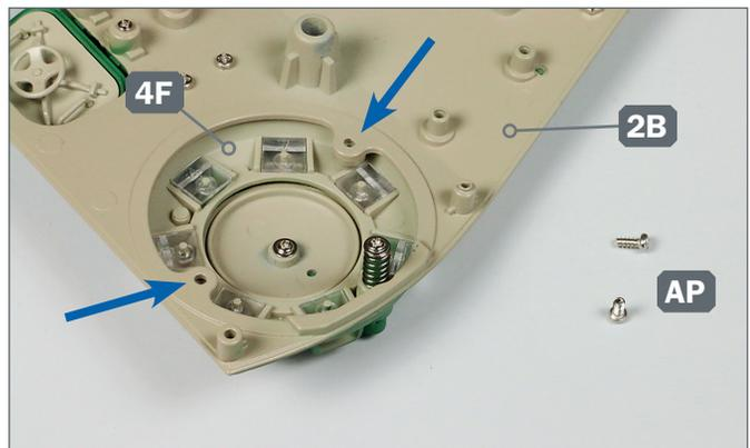
**6 ▶** Der Ring 4F ist korrekt auf das Turmdach 2B gesetzt, wenn die Bohrungen beider Teile (Pfeile) übereinstimmen. Legen Sie zwei Schrauben AP bereit.
