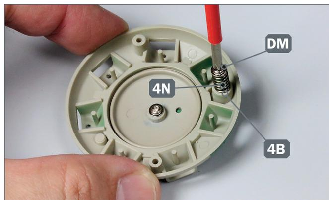
**6** ▶ Drücken Sie die aufgesetzte Feder 4N leicht zusammen und ziehen Sie die Schraube DM in der Bohrung des langen Zapfens von 4B fest, wie abgebildet.
