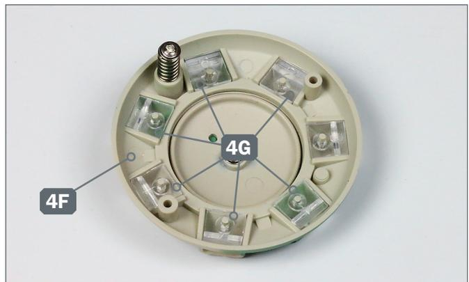
**4 ▶** Wiederholen Sie den Arbeitsschritt mit den sechs übrigen Prismenspiegeln 4G: Sie werden in die sechs anderen Öffnungen des Rings 4F eingefügt.
