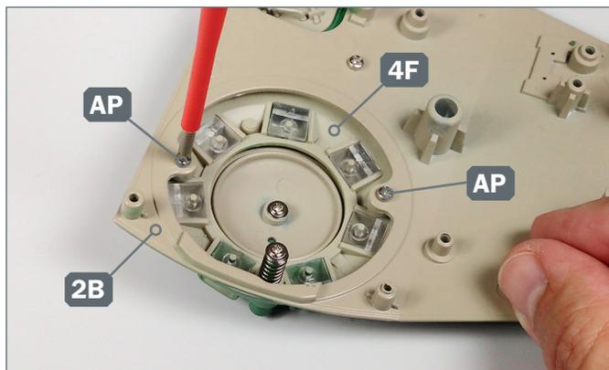
**7** ▶ Fixieren Sie den Ring 4F am Turmdach 2B, indem Sie an dessen Unterseite die beiden Schrauben AP eindrehen, wie es das Foto zeigt.
