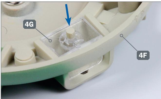
**3 ▶** Platzieren Sie die mit Kleber versehene Bohrung des Prismenspiegels 4G auf einem Zapfen (Pfeil) des Rings 4F und drücken Sie den Spiegel vorsichtig hinunter.
