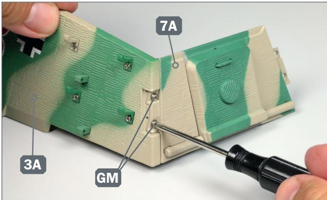
**7** ▶ Befestigen Sie die Turmrückwand 7A mit den beiden Schrauben GM an der linken Turmwand 3A, wie es das Foto zeigt.
