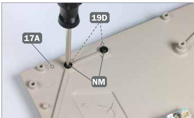
**5** ► Halten Sie die beiden Füße 19D in Position, während Sie die Panzerwanne 17A umdrehen. Fixieren Sie die Füße mit je einer Schraube NM an der Panzerwanne.
