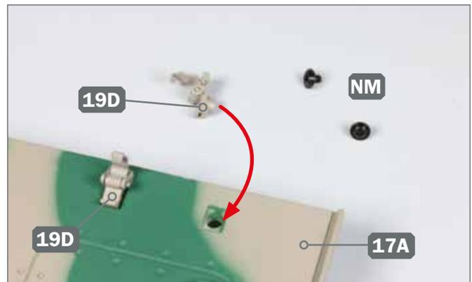
**4** ► Platzieren Sie die Füße 19D der beiden Halterungen in den Bohrungen vorne links auf dem Oberteil der Panzerwanne 17A. Legen Sie zwei Schrauben NM bereit.
