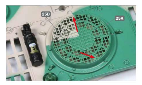
Kleben Sie das Schutzgitter 25D auf der Lüfterabdeckung 25A fest: Seine beiden Aussparungen umfassen die kleinen Zapfen der Abdeckung, siehe Pfeile.
