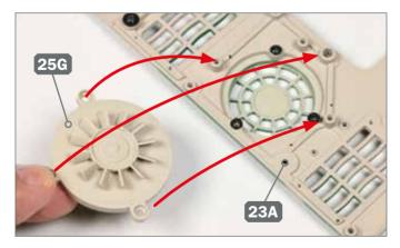
Nehmen Sie die Lüfter-Baugruppe und führen Sie die Laschen des Bodenteils 25G zu den Schraubenaufnahmen an der Unterseite vom Oberteil der Panzerwanne 23A, wie angedeutet.
