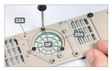
3 ► Fixieren Sie die Lüfterabdeckung 25A am Oberteil der Panzerwanne 23A, indem Sie die drei Schrauben GP in die Bohrungen beider Teile eindrehen.
