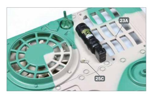
5 ➤ Der dunkelgelbe Haken 25C wird in der Vertiefung auf dem Oberteil der Panzerwanne 23A festgeklebt, die in der gleichen Farbe lackiert ist.
