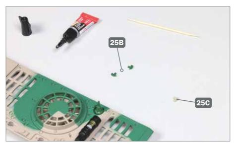
4 ➤ Legen Sie die zwei grünen Haken 25B und den dunkelgelben Haken 25C bereit. Zum Fixieren werden die Zapfen der Haken jeweils mit einem Tropfen Sekundenkleber versehen. Zum punktgenauen, sparsamen Auftrag des Klebers verwenden Sie einen Zahnstocher oder einen ähnlichen geeigneten Gegenstand.
