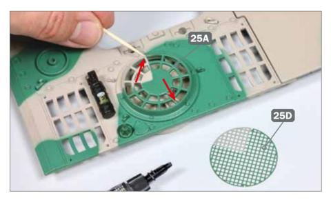
7 ► Legen Sie das rechte Schutzgitter 25D bereit. Versehen Sie die beiden kleinen Zapfen auf der Lüfterabdeckung 25A mit etwas Sekundenkleber: Die Pfeile weisen auf die Stellen. Zusätzlich können Sie auch etwas Klebstoff auf die Streben der Abdeckung auftragen.
