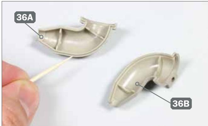
**1** ► Legen Sie die beiden Hälften des Auspuffrohrs 36A und 36B auf Ihre Arbeitsplatte. Versehen Sie den Rand von 36A sparsam mit Sekundenkleber.
