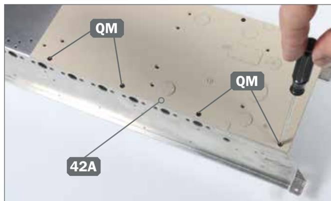
**4** ▶ Vier weitere Schrauben QM werden am rechten Rand des Bodenteils 42A eingedreht.
