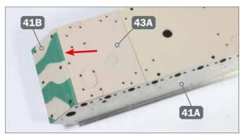
2 ► Richten Sie das Bodenteil 43A exakt auf der Unterwanne 41A aus. Achten Sie darauf, dass das Bodenteil bündig mit der Frontabdeckung 41B abschließt (Pfeil).
