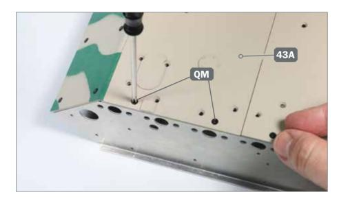
4 ► Am rechten Rand des Bodenteils 43A werden ebenfalls zwei Schrauben QM eingedreht.
