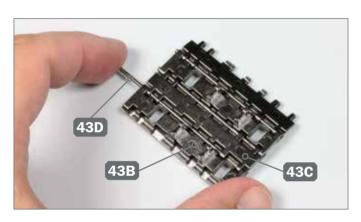
3 ► Fügen Sie das verbliebene Kettenglied 43B an der freien Seite des Kettenglieds 43C ein und sichern Sie die beiden mit einem Verbindungsstift 43D aneinander.
