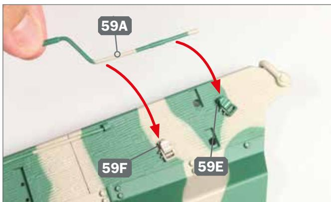
**3** ▶ Öffnen Sie die Verschlüsse der Halterungen 59E und 59F hinten am Seitenteil und fügen Sie die Andrehkurbel 59A in die Halterungen ein, wie angedeutet.
