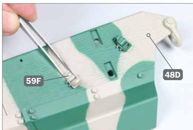
**10** ▶ Fügen Sie einen der dunkelgelben Halterungsfüße 59F, wie abgebildet, in die Bohrung auf dem Wannenseitenteil 48D ein.
