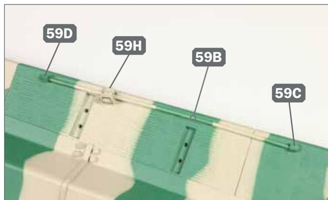
**2** ▶ Die Enden der Brechstange 59B sind in die Halterungen 59C und 59D eingefügt. Sichern Sie die Stange, indem Sie den Verschluss 59H der Halterung schließen.
