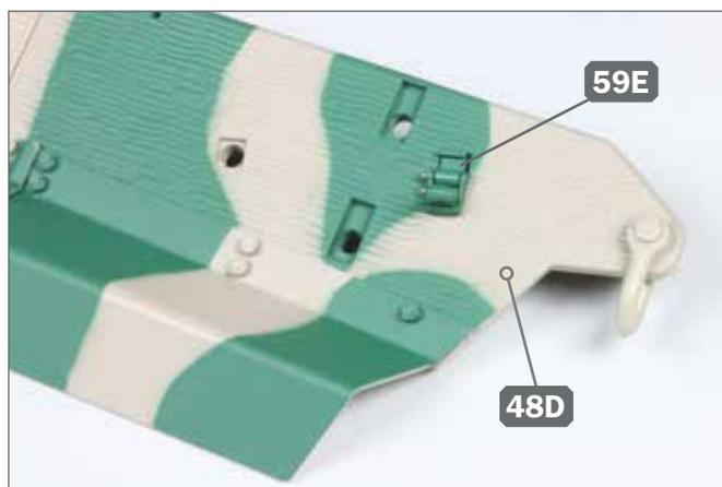
**8** ▶ Legen Sie die Wannenseitenteil-Baugruppe auf Ihre Arbeitsplatte. Platzieren Sie den olivgrünen Halterungsfuß 59E in der Bohrung ganz hinten auf dem Wannenseitenteil 48D, wie abgebildet.
