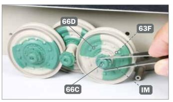
Befestigen Sie das Laufrad 66D/66F mit der Schraube IM am Achsschenkel 63F. Bringen Sie anschließend den Nabendeckel 66C am Laufrad an.
