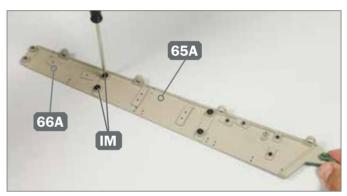
2 ► Befestigen Sie die beiden Wannenseitenteile 65A und 66A aneinander, indem Sie an deren Innenseiten zwei Schrauben IM eindrehen, wie abgebildet.
