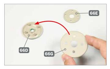
Legen Sie die Lochscheibe 66E und das äußere Laufrad 66D bereit. Nehmen Sie die Lochscheibe 66G und platzieren Sie sie auf dem Laufrad, wie angedeutet.
