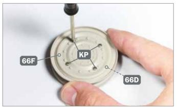
6 ► Drehen Sie das Doppellaufrad vorsichtig um und bringen Sie die vier Löcher der beiden Baugruppen zum Fluchten. Ziehen Sie darin vier Schrauben KP fest.
