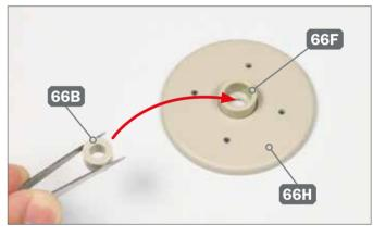
4 ► Die Lochscheibe 66H liegt auf dem Laufrad 66F. Fügen Sie die Manschette 66B in die Nabe des Laufrads ein, wie es der Pfeil andeutet.
