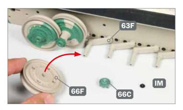
Legen Sie den Nabendeckel 66C und eine Schraube IM bereit. Führen Sie das Laufrad 66F zum dritthintersten Achsschenkel 63F, wie abgebildet.
