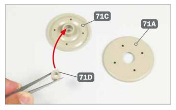
3 Legen Sie das innere Laufrad 71C und die Lochscheibe 71A bereit. Führen Sie die Manschette 71D zur Nabe an der Innenseite des Laufrads 71C.
