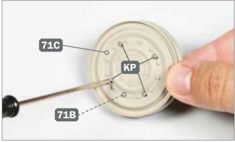
Fixieren Sie die beiden Laufrad-Baugruppen 71B und 71C aneinander, indem Sie die vier Schrauben KP an der Außenseite des inneren Laufrads eindrehen.
