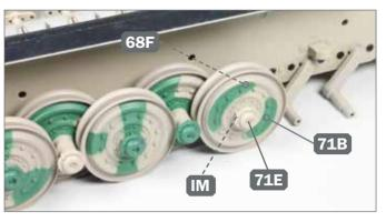
Befestigen Sie das Laufrad 71B/71C mit der Schraube IM am Achsschenkel 68F und setzen Sie anschließend den Nabendeckel 71E auf das Laufrad.
