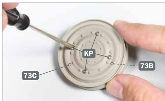
**6** ► Fixieren Sie die beiden Laufrad-Baugruppen 73B und 73C aneinander, indem Sie die vier Schrauben KP an der Außenseite des inneren Laufrads eindrehen.
