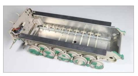
▶ Die zweite Leitradaufhängung ist zusammengebaut und mit der ersten über eine Achse verbunden. Die Baugruppe wurde in der Panzerwanne montiert, die Achsschenkel der beiden Leiträder sind ebenfalls am Modell angebracht.
