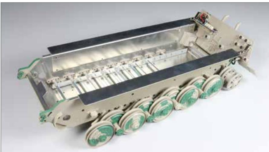
▶ Sechs weitere Drehstäbe sind in der Panzerwanne angebracht. Das erste Leitrad ist zusammengebaut und an der Leitradachse befestigt.
