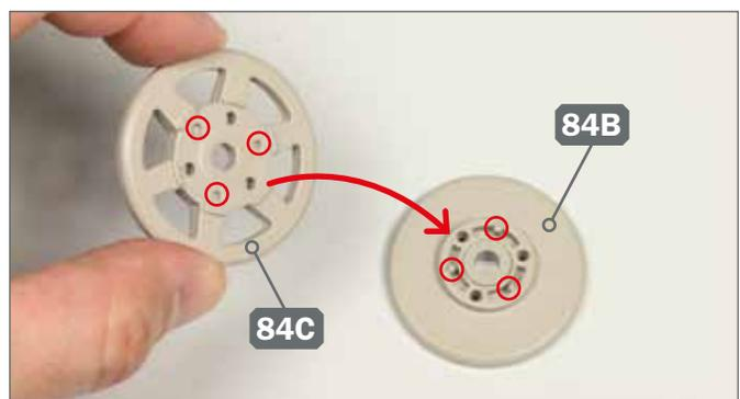
**2** ▶ Setzen Sie das Leitrad-Mittelteil 84C auf das Leitrad-Innenteil 84B: Die drei Zapfen von 84B gehören in die Vertiefungen von 84C (alle eingekreist).
