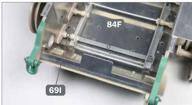
**3** ▶ Das andere Ende des ersten Drehstabs 84F gehört in den Schlitz des vordersten rechten Achsschenkels 69I, wie abgebildet.
