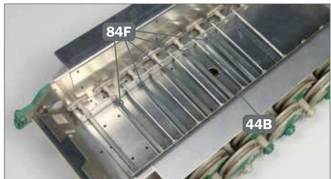
**4** ▶ Wiederholen Sie den Arbeitsschritt mit den fünf übrigen Drehstäben 84F: Sie gehören in die nächsten Schlitzte der linken Drehstabstütze 44B sowie der entsprechenden rechten Achsschenkel, wie abgebildet.
