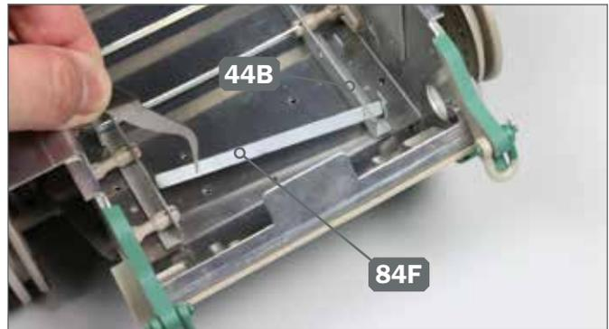
**2** ▶ Fügen Sie das eine Ende des ersten Drehstabs 84F in den vordersten Schlitz der linken Drehstabstütze 44B ein, wie abgebildet.
