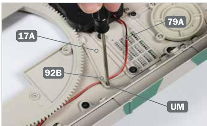
**5** ► Platzieren Sie eine Kabelführung 92B im hinteren Bereich der Panzerwanne 17A über dem Kabel 79A und befestigen Sie sie mit einer Schraube UM.
