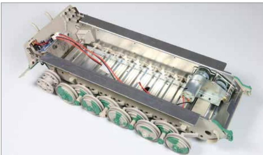
▶ Die linke Antriebseinheit ist in der Unterwanne des Panzers montiert.
