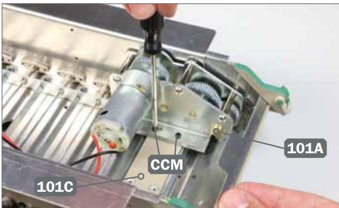
**9** ▶ Fixieren Sie das Antriebsgehäuse 101A mit zwei Schrauben CCM an der Halteplatte 101C.
