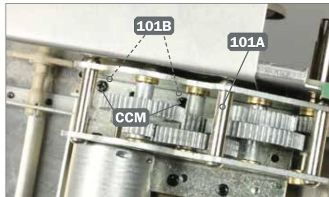
**10** ▶ Mit zwei weiteren Schrauben CCM wird das Antriebsgehäuse 101A an den beiden Muttern 101B befestigt, wie im Foto dargestellt.
