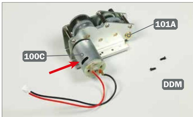
**1** ▶ Fügen Sie die Welle vom Fahrmotor 100C in das Antriebsgetriebe 101A ein. Achten Sie dabei auf die Ausrichtung des Motors (der Pfeil weist auf den Schlitz im Motorgehäuse). Legen Sie zwei Schrauben DDM bereit.
