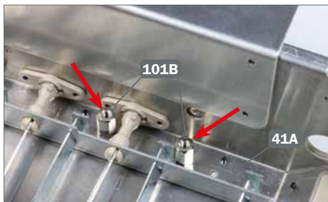
**4** ▶ Platzieren Sie die beiden Muttern 101B links vorne in der Unterwanne 41A. Bei beiden Muttern muss die Seite mit dem breiteren Rand nach oben weisen (Pfeile).
