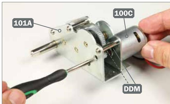
**2** ▶ Fixieren Sie den Fahrmotor 100C mit den zwei Schrauben DDM am Antriebsgetriebe 101A. Der Schraubendreher wird dazu durch die Löcher im Getriebe geführt, wie abgebildet.
