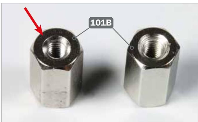
**3** ▶ Legen Sie die beiden Sechskantmuttern 101B bereit. Beachten Sie, dass die Muttern zwei leicht unterschiedliche Seiten haben. Bei der Mutter links im Bild weist der etwas breitere Rand (Pfeil) nach oben.
