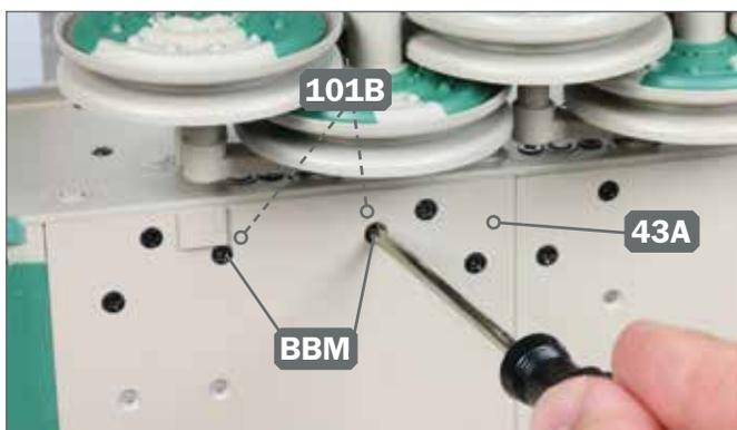
**5** ▶ Halten Sie die Muttern 101B in Position und befestigen Sie sie mit je einer Schraube BBM, die Sie von unten in das Bodenteil der Unterwanne 43A eindrehen.
