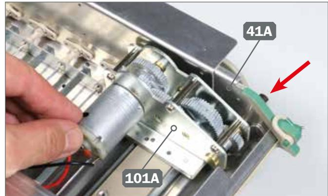
**8** ▶ Fügen Sie das Antriebsgehäuse 101A in die Unterwanne 41A ein. Führen Sie dabei die Antriebswelle durch die Bohrung der Unterwanne (Pfeil).
