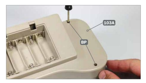
Am anderen Ende der Rückseite der Fernbedienung 103A werden die übrigen zwei Schrauben BP eingedreht, wie es das Foto zeigt.
