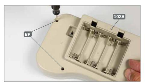
■ Befestigen Sie die beiden Hälften der Fernbedienung aneinander, indem Sie in die Bohrungen am einen Ende der Rückseite 103A zwei Schrauben BP eindrehen, wie abgebildet.
