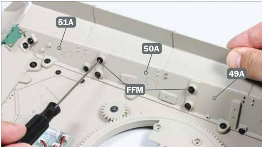
**4** ▶ Gleiches Spiel auf der linken Wannenseite: Entfernen Sie die beiden im Detailbild abgebildeten Schrauben IM. Ersetzen Sie diese durch zwei Schrauben FFM, wie im Foto links gezeigt.
