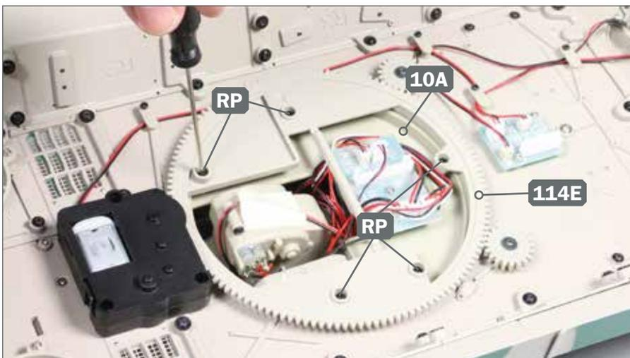
**5** ▶ Platzieren Sie den Turm vorsichtig unter der Oberwanne (Detailbild) und befestigen Sie die Bodenplatte des Turms 10A mit fünf Schrauben RP am Turmdrehkranz 114E, wie abgebildet.
