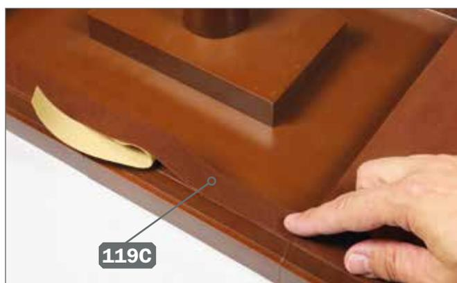
**4** ► Lösen Sie sukzessive die Trägerfolie vom Stoffabschnitt 119C und kleben Sie diesen auf den Bodenteilen fest.
