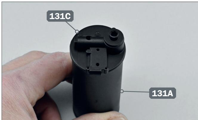
**1** ▶ Montieren Sie den unteren Deckel 131C auf das Ende des Ölkühlers 131A, das mit den kleineren Bohrungen versehen ist.
