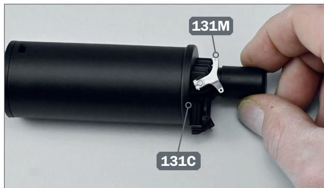
**6** ▶ Positionieren Sie den Hebel 131M in der Aussparung auf dem Deckel 131C.
