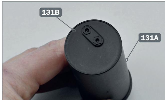
**2** ▶ Montieren Sie den oberen Deckel 131B auf das andere Ende des Ölkühlers 131A, das mit den größeren Bohrungen versehen ist.
