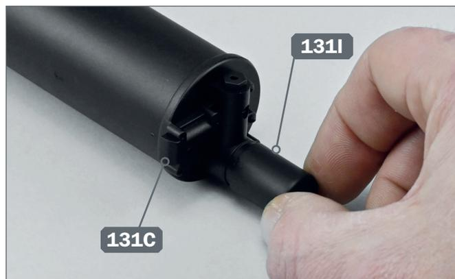
**4** ▶ Setzen Sie die Kühlwasser-Eintrittsstelle 131I in die entsprechende Position im Deckel 131C. Richten Sie dafür die Teile wie auf dem Foto gezeigt aus.
