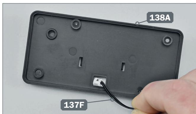
**6** ▶ Führen Sie den Kabelbolzen der Leiterplatte 137F in die rechteckige Öffnung auf der Hinterseite der Steuerplatte 138A ein.
