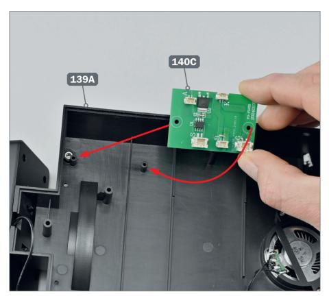
Nehmen Sie den oberen Teil des Motorsockels 139A zur Hand und setzen Sie die Elektronikplatine 140C in der auf dem Foto angegebenen Position ein.
