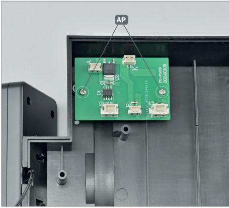
2 ► Überprüfen Sie, ob die elektronische Platine wie auf dem Foto ausgerichtet ist, und befestigen Sie sie mit zwei Schrauben AP.
