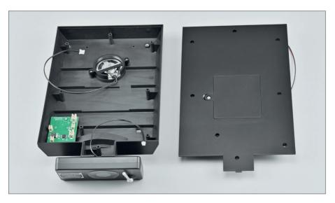
► Sie haben die elektronische Platine und den Deckel der Batteriehalterung montiert.
