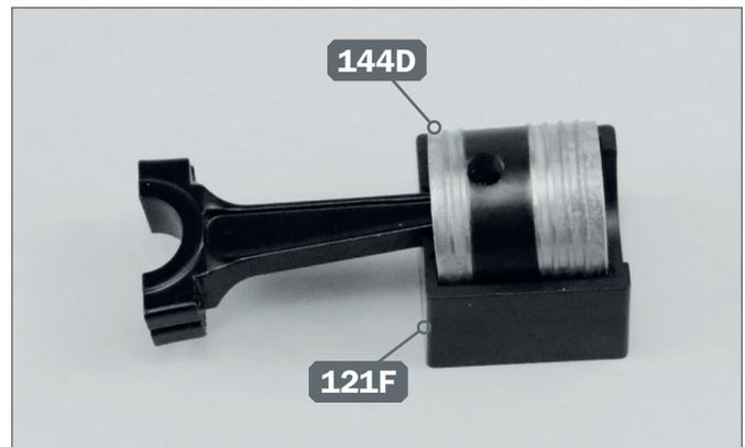
**4** ► Setzen Sie den Kolben 144D in die Schablone 121F.
