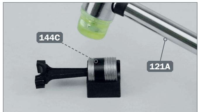
**6** ► Verwenden Sie den Hammer 121A, um den Kolbenbolzen 144C ganz hineinzudrücken. Entfernen Sie anschließend den Kolben aus der Schablone 121F und bewahren Sie sie auf.
