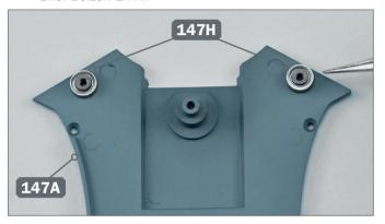
¶ Montieren Sie die beiden Lager 147H an den gelochten Stiften der hinteren Motorplatte 147A, wie auf dem Foto gezeigt. Richten Sie die beiden Lager dazu wie abgebildet aus.
