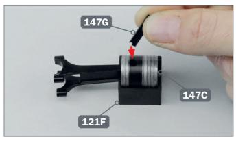
5 ► Setzen Sie den Kolben 147C in die Schablone 121F und stecken Sie dann den Bolzen 147G in das Loch im Kolben.
