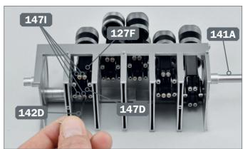
2 ► Stecken Sie den Kolben in den bereits vorhandenen Kolben ein. Befestigen Sie die Pleuelstange 127F mit dem doppelten Pleueldeckel 147D und vier Bolzen 147I. Ziehen Sie die Bolzen mit dem Inbusschlüssel 142D fest.
