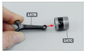
**4** ► Stecken Sie die Pleuelstange 147B wie gezeigt in den Kolben 147C. Richten Sie den Ring am Ende der Pleuelstange an den Löchern im Kolben aus.
