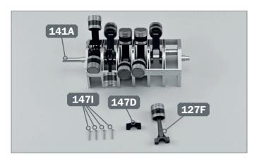
1 ► Nehmen Sie die Baugruppe der Kurbelwelle 141A und den in Ausgabe 127 montierten Kolben (Pleuelstange 127F) zur Hand. Legen Sie sie zusammen mit dem doppelten Pleueldeckel 147D und vier Bolzen 147I auf Ihre Arbeitsfläche.
