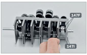
S Schließen Sie die Befestigung der einzelnen Pleueldeckel 147F ab, indem Sie die letzten beiden Bolzen 147I in den verbleibenden Löchern festziehen.
