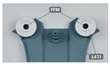
10 ► Montieren Sie die beiden Zahnräder 147J auf denselben gelochten Stiften über den beiden Lagern. Richten Sie sie wie auf dem Foto gezeigt aus und befestigen Sie sie mit zwei Schrauben FFM.
