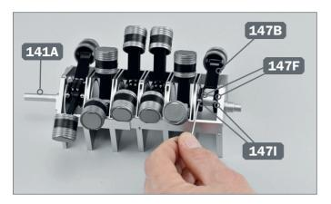
**7** ► Montieren Sie den Kolben mit Pleuelstange 147B an der Kurbelwelle 141A in der auf dem Foto gezeigten Position. Stecken Sie die beiden einzelnen Pleueldeckel 147F auf die Enden und befestigen Sie sie mit zwei Bolzen 147I.
