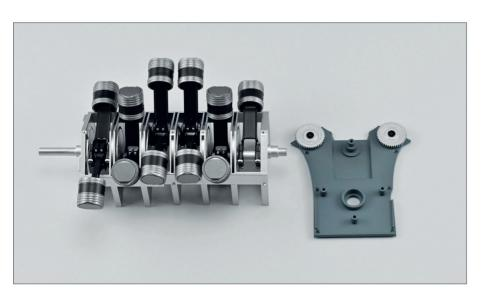
➤ Sie haben zwei neue Kolben auf der Kurbelwelle und die beiden Zahnräder auf der hinteren Motorplatte montiert.
