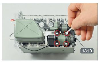
S > Setzen Sie die zwei Schellen und vier Bolzen, die Sie in Schritt 1-2 entfernt haben, wieder ein und befestigen Sie den neuen Anlasser mit dem Schlüssel 131D in seinem Gehäuse.
