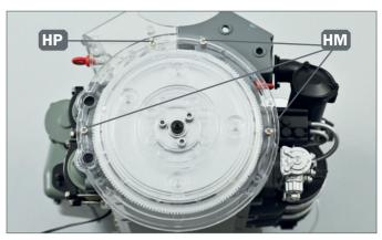
■ Befestigen Sie die transparente Abdeckung, indem Sie drei Schrauben HM und eine Schraube HP in den angegebenen Löchern festziehen.
