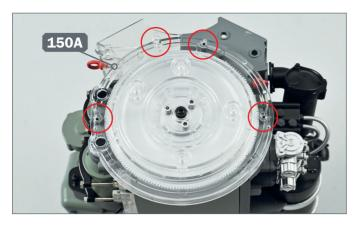
7 ► Montieren Sie die transparente Abdeckung 150A auf dem Schwungrad, indem Sie die Teile wie abgebildet ausrichten. Achten Sie auf die korrekte Position der durch die Kreise auf dem Foto markierten Löcher.
