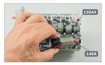
**7** ► Montieren Sie den neuen Anlasser 135AX an seine Position an der Seite des Motors, indem Sie zuerst sein Zahnrad in das Loch der Motorplatte 145A einführen.
