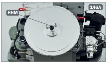
▶ Befestigen Sie das Schwungrad 146A mit der Schraube HHM inklusive Abstandshalter und Unterlegscheibe. Ziehen Sie die Schraube nicht ganz fest, die Zahnräder müssen sich ohne Schwierigkeiten drehen lassen.
