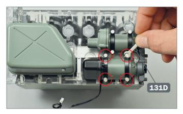
1 ► Legen Sie die Motorbaugruppe auf Ihre Arbeitsfläche. Lösen Sie mit dem Schlüssel 131D die vier Bolzen, mit denen die Anlasser-Baugruppe befestigt ist.
