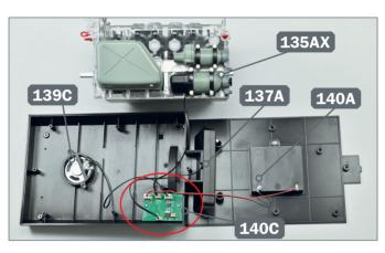
10 ► Nehmen Sie auch den oberen Teil des Motorsockels heraus. Verbinden Sie die Kabel des neuen Anlassers 135AX (Buchstabe "B"), des Lautsprechers 139C (Buchstabe "S"), der Steuerplatte 137A (Buchstabe "K") und des unteren Teils 140A (Buchstabe "G") mit den entsprechenden Buchsen der Platine 140C.
