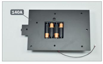
Nehmen Sie den unteren Teil des Motorsockels 140A heraus. Öffnen Sie den Deckel des Batteriehalters und legen Sie vier AA-Batterien ein, achten Sie dabei auf die angegebene Polarität. Schließen Sie anschließend den Deckel wieder.
