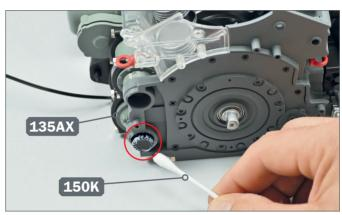
2 ► Verwenden Sie das Wattestäbchen 150K, um einen Fettfilm auf das Zahnradprofil des neuen Anlassers 135AX aufzutragen.
