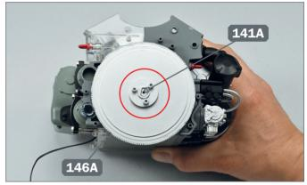
♣ Montieren Sie das Schwungrad 146A an der Vorderseite des Motors und führen Sie das Ende der Kurbelwelle 141A durch das Mittelloch des Schwungrads.
