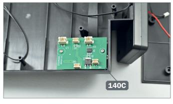
12 ► Achten Sie darauf, die Komponenten nicht zu beschädigen und trennen Sie das Kabel von der Platine 140C. Entfernen Sie die Batterien aus dem Batteriehalter.
