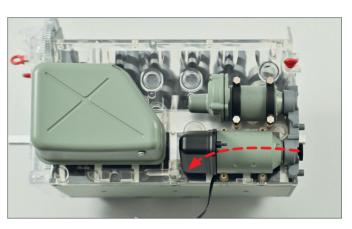
2 ► Entfernen Sie vorübergehend die vier Bolzen und die beiden Schellen, mit denen der Anlasser befestigt ist, und ziehen Sie den Anlasser aus seinem Gehäuse.
