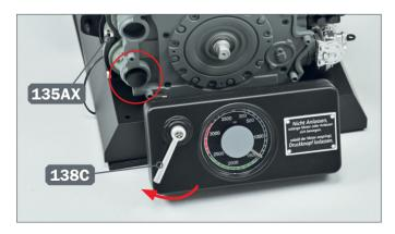
11 ► Betätigen Sie den Steuerhebel 138C, um zu prüfen, ob das Getriebe des neuen Anlassers 135AX ordnungsgemäß funktioniert. Bringen Sie anschließend den Steuerhebel wieder in seine Ausgangsposition zurück.
