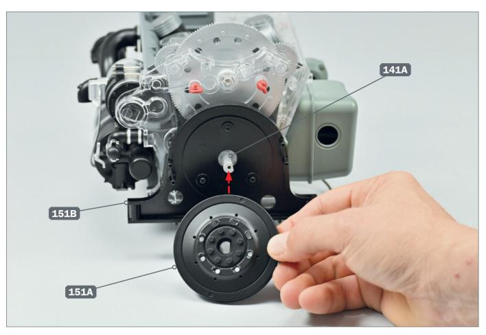
3 ► Montieren Sie den Schwingungsdämpfer 151A auf dem Motorschild 151B. Richten Sie die Teile dazu wie abgebildet aus. Führen Sie das Ende der Kurbelwelle 141A durch das Mittelloch des Schwingungsdämpfers.
