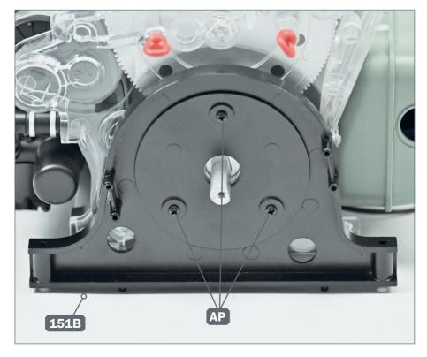
■ Befestigen Sie das Motorschild 151B, indem Sie die drei Schrauben AP in den angegebenen Löchern festziehen.
