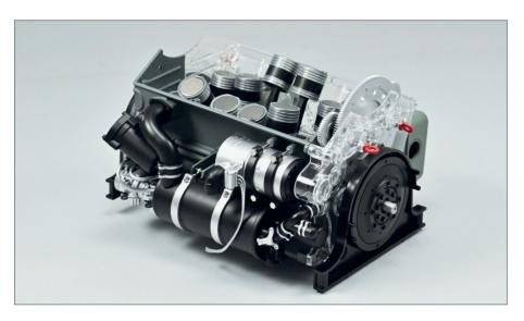
▶ Das Motorschild und der Schwingungsdämpfer wurden auf der Rückseite des Motors installiert.
