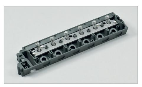
► Die ersten sechs Tellerventile wurden auf die linke Hälfte des Motorkopfes montiert.
