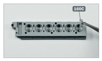
3 ► Drehen Sie die Baugruppe um und setzen Sie von der Oberseite des Motorkopfes ein Tellerventil 160C in die Vertiefung ein, die mit der Stützplatte übereinstimmen.
