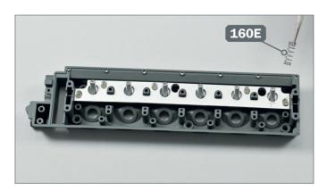
5 Drehen Sie die Gruppe erneut um. Montieren Sie eine Feder 160E auf den Schaft eines Tellerventils.
