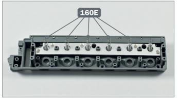
**6** ► Montieren Sie die restlichen fünf Federn 160E auf die Schäfte der anderen Tellerventile.
