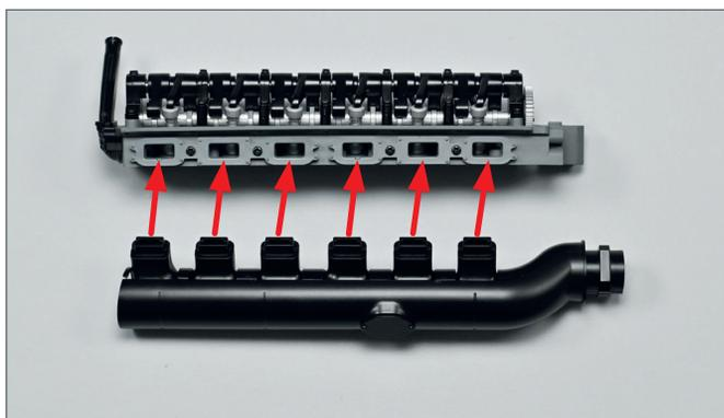
**5** ▶ Nehmen Sie die linke Hälfte des Motorkopfes zur Hand, die Sie in den vorherigen Ausgaben zusammengebaut haben. Bauen Sie das Auspuffrohr daran an, indem Sie die Krümmer in die Dichtungsöffnungen stecken.
