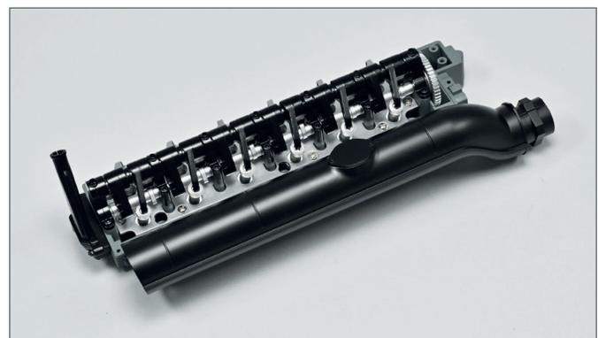
**6** ▶ Versichern Sie sich anhand des Fotos, dass das Auspuffrohr korrekt mit der linken Hälfte des Motorkopfes verbunden ist.
