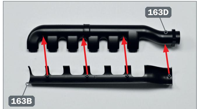
**2** ▶ Installieren Sie die Innenabdeckung 163B am inneren Teil des Auspuffrohrs 163D.
