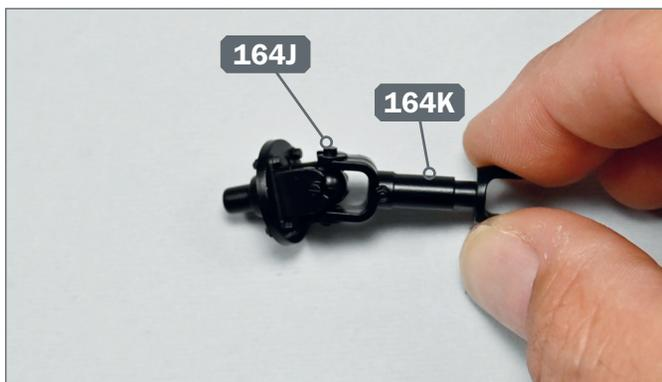
**3 ▶** Verbinden Sie die Welle 164K mit dem Kreuzgelenk 164J. Richten Sie die Welle wie abgebildet aus: Sie müssen das Ende mit der breiteren Gabel auf das Kreuz stecken.
