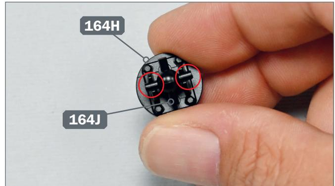
**2 ▶** Verbinden Sie das Kreuzgelenk 164J mit der Innenverbindung 164H.
