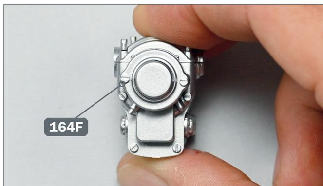
**6** ▶ Montieren Sie den linken Deckel 164F an den linken Magnetzünder. Die Teile können nur in einer Richtung zusammengefügt werden.
