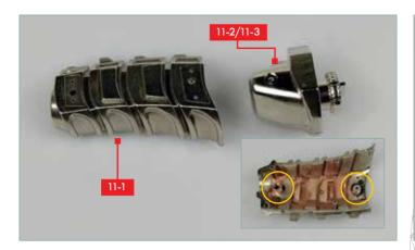
Lege das Halsbauteil **11-1** und die in Ausgabe 11 zusammengebaute Halsgelenkbaugruppe **11-2/11-3** wie gezeigt auf die Arbeitsplatte. Beachte die gelb eingekreisten Schraublöcher an der Unterseite von **11-1** (siehe eingesetztes Foto).
