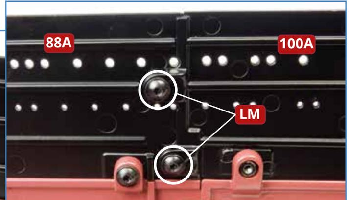
**2** Fixieren Sie den Rumpfabschnitt **100A** mit fünf Sechskantschrauben **LM** an den Rumpfabschnitten **88A** und **99A**. Verwenden Sie zum Festziehen der Schrauben einen Inbuschlüssel (Innensechskant).
