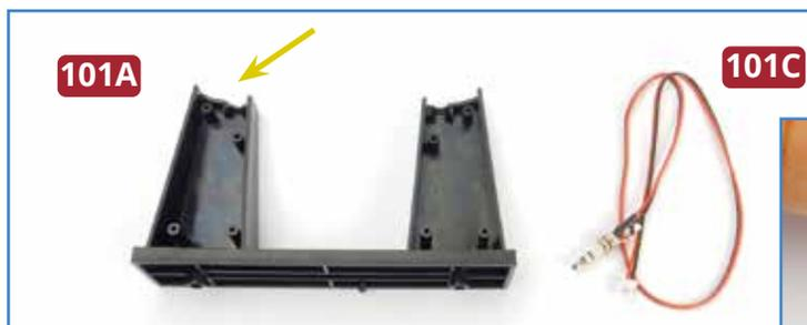
**1** Fügen Sie den Metallkontakt des Kabels **101C** in die Vertiefung der Stütze **101A** ein, und zwar auf der Seite, auf die der gelbe Pfeil oben weist. Der Hals des Kontakts wird so in der Aufnahme der Stütze positioniert, wie es das Foto unten zeigt. Führen Sie dann den Kunststoffstecker am anderen Ende des Kabels durch das Loch am Boden der Stütze (unten rechts).
