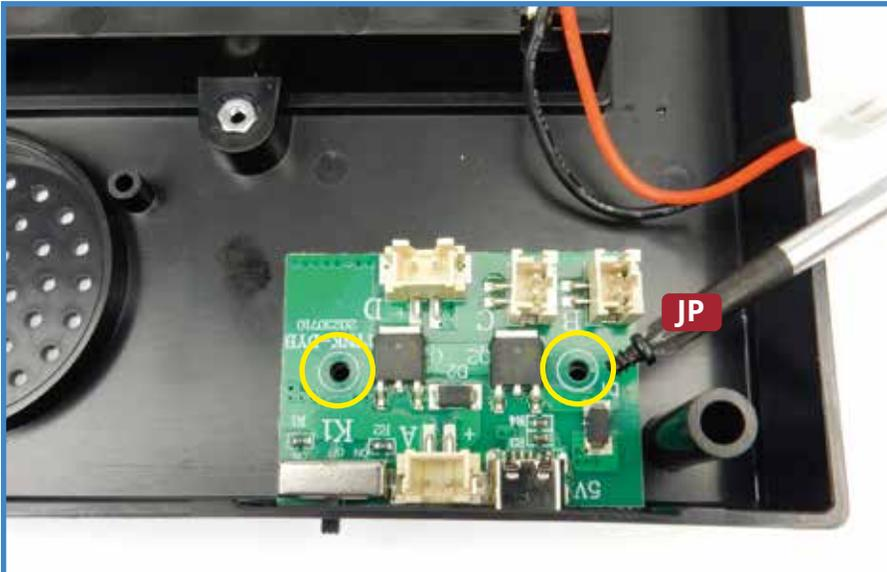
**2** Fixieren Sie die Platine **104B** an der Batteriebox, indem Sie zwei Schrauben **JP** eindrehen. Ziehen Sie die Schrauben nicht zu fest an, da dies die Platine beschädigen könnte.
