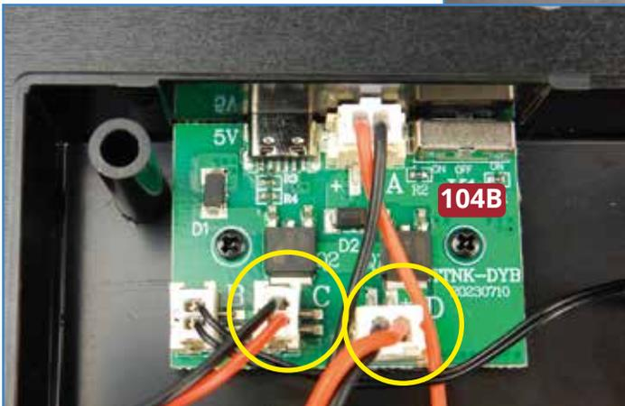
**4** Legen Sie die Batteriebox **104A** auf die Bodenplatte des Ständers **103A**, wie oben abgebildet. Verbinden Sie die Stecker der beiden Kabel **C** und **D** mit den entsprechenden Ports der Platine **104B** (links gelb eingekreist).
