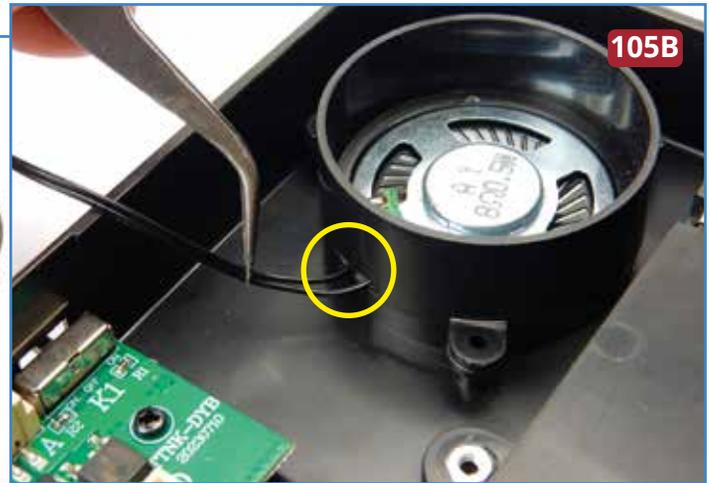
**2** Legen Sie die Batteriebox **104A** verkehrt herum auf Ihre Arbeitsplatte. Halten Sie die Lautsprecher-Baugruppe in Position und setzen Sie sie so in die Box ein, dass die Löcher der Halterung **105B** mit den Schraubenaufnahmen in der Box **104A** fluchten. Achten Sie darauf, dass sich die Vertiefung mit dem Kabel auf der der Platine zugewandten Seite befindet. Fixieren Sie die Halterung mit drei Schrauben **BP**.
