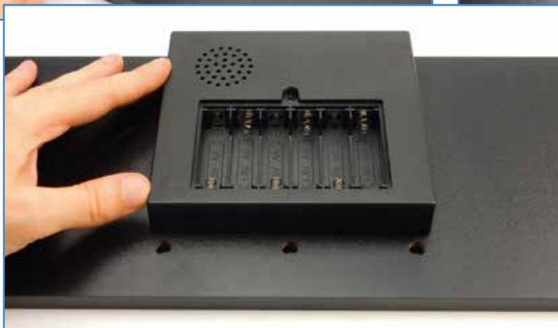
**5** Achten Sie darauf, dass die beiden Kabel **C** und **D** weit genug durchgezogen sind. Drehen Sie die Batteriebox **104A** um und positionieren Sie sie so auf der Bodenplatte des Ständers **103A**, dass die Schraubenlöcher beider Teile fluchten. Drehen Sie die Bodenplatte um, damit Sie die Batteriebox mit den vier Kombischrauben **105C** fixieren können (eingekreist, oben).
