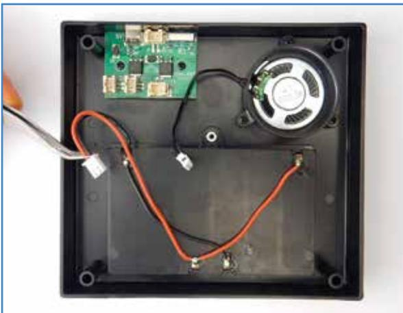
**3** Verbinden Sie den Stecker des vom Batteriefach kommenden Kabels mit dem Port **A** der Platine **104B**. Der Stecker vom Lautsprecher-Kabel wird in den Port **B** eingefügt (beide Stecker sind unten eingekreist).
