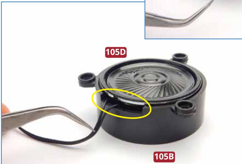
**1** Legen Sie den Lautsprecherhalter **105B** bereit. Setzen Sie den Lautsprecher **105D** so in den Halter ein, dass die Kabel durch dessen Vertiefung laufen (eingekreist).
