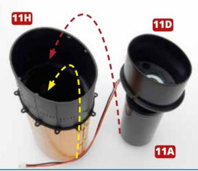
Am Fuß des Schornsteins befindet sich eine quadratische Öffnung (links, gelb eingekreist). Nehmen Sie die Tank-Baugruppe und führen Sie das Ende vom Kabel des Rauchgenerators **3S** durch diese Öffnung (rechts, gelber Pfeil), während Sie den Tank in den Schornstein einfügen (roter Pfeil). Es kann hilfreich sein, den Stecker von unten mit einer Pinzette zu greifen und ihn durch die Öffnung hinauszuführen.
