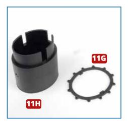
Tstellen Sie die obere Verkleidung 11H verkehrt herum auf Ihre Arbeitsplatte (links). Nehmen Sie den Kragen 11G und setzen Sie ihn so auf die Verkleidung, dass sich seine beiden Zapfen in die seitlichen Schlitze der Verkleidung einfügen. Achten Sie darauf, dass die Zapfen/Schlitze unterschiedlich breit sind und dass die flachere Seite des Kragens nach oben weist. Verwenden Sie keinen Klebstoff.
