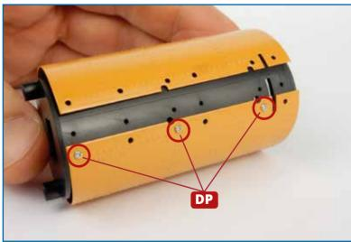
Zunächst werden drei Schrauben **DP** in den eingekreisten Löchern am einen Ende der Verkleidung befestigt (oben). Anschließend werden drei weitere Schrauben **DP** in die entsprechenden Löcher am anderen Ende der Verkleidung eingedreht (rechts).
