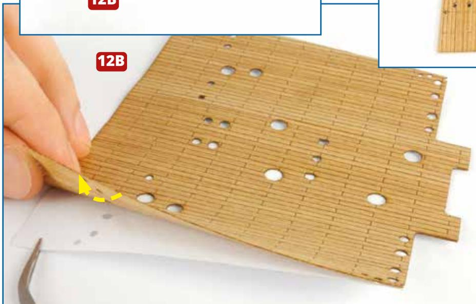
**1** Richten Sie den hölzernen Decksbelag **12B** und das vordere C-Deck **12A** so aus, wie oben links gezeigt. Ziehen Sie ganz vorsichtig die Schutzfolie vom Decksbelag ab (links). Achten Sie beim Verlegen des Decksbelags auf dem Deck darauf, dass alle Schraubenlöcher und Bohrungen beider Teile fluchten (oben). Glätten Sie gegebenenfalls auftretende Unebenheiten sofort mit einem weichen Tuch.
