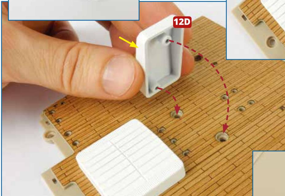
**3** Die flachere Seite der kleinen Ladeluke **12D** weist ebenfalls nach vorne (links, Pfeil). Setzen Sie die Luke auf und befestigen Sie auch sie mit zwei von unten in das Deck eingedrehten Schrauben **CP** (unten).
