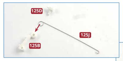
Legen Sie das Vorderteil des Krankörpers 125B, den Verbindungsstift 125D und das Krankabel 125J bereit. Platzieren Sie die größere Drahtschlaufe am Ende des Kabels rings um die erhöhte Bohrung des Krankörpers (oben). Halten Sie das Kabel in Position, indem Sie den Zapfen des Verbindungsstifts in die Bohrung stecken (rechts). Nehmen Sie das Hinterteil des Krankörpers 125A und fügen Sie es mit dem Vorderteil zusammen (unten).
