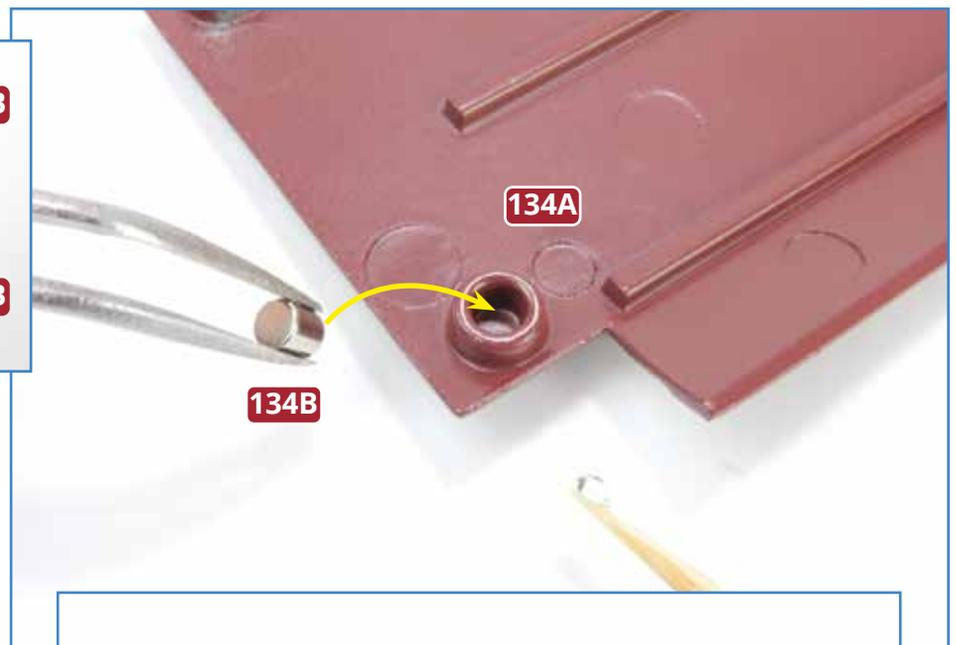
**1** Legen Sie die Abdeckung **134A** und die vier Magnete **134B** auf Ihre Arbeitsplatte. Kleben Sie die Magnete in den Aufnahmen an den vier Ecken der Abdeckung fest. Lassen Sie den Kleber trocknen.
