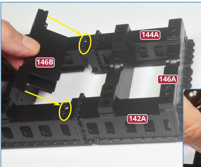
**3** Nehmen Sie den Querträger **146B** und fügen Sie ihn so in die Bodenteil-Baugruppe ein, dass seine Zapfen in den Schraubenlöchern der Längsträger **144A** und **142A** sitzen (links gelb eingekreist). Drehen Sie die Baugruppe um und befestigen Sie den Querträger mit zwei Schrauben **QP** (unten gelb eingekreist).
