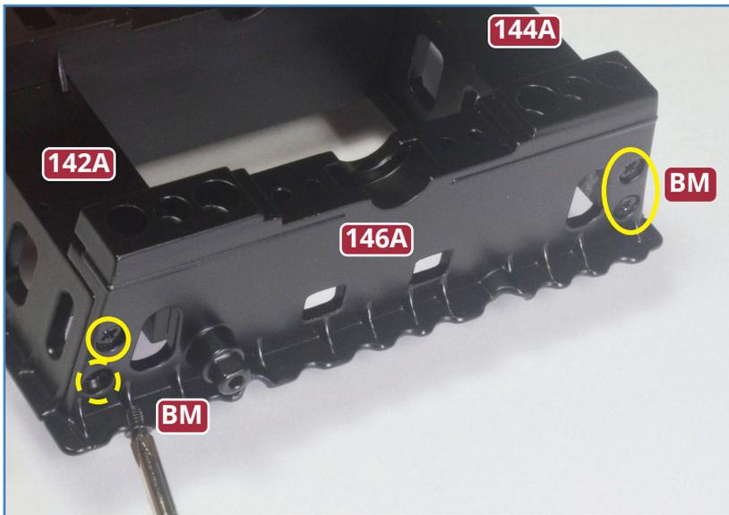
**2** Drehen Sie das Bodenteil um und befestigen Sie das Endstück **146A** von außen mit vier Schrauben **BM** (links gelb eingekreist). Legen Sie die vier Abdeckkappen **146I** bereit. Geben Sie etwas Sekundenkleber auf die Innenseiten der Abdeckkappen und fixieren Sie jeweils eine über den vier Schrauben **BM** (unten).
