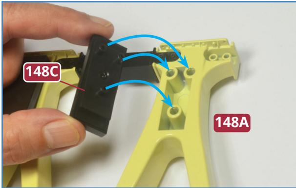
**4** Fügen Sie die drei Zapfen der Seitenverkleidung **148C** in die Aufnahmen der Säule **148A** ein (blaue Pfeile). Es handelt sich hierbei um eine Steckverbindung.
