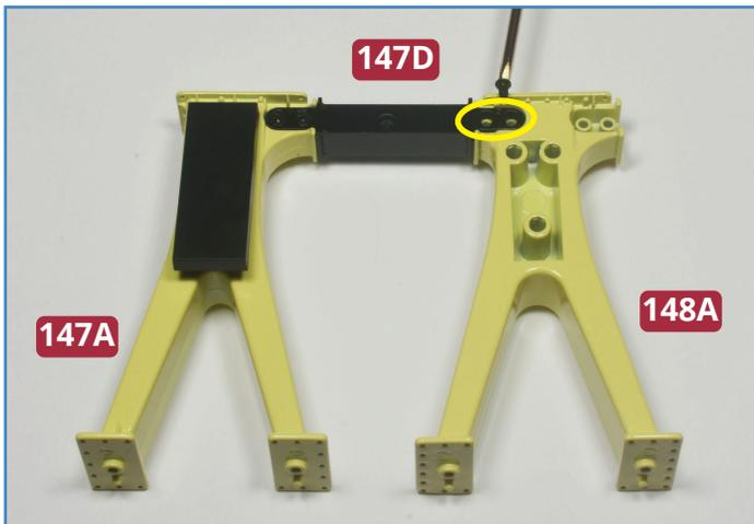
**2** Befestigen Sie den Verbindungssteg **147D** mit zwei Schrauben **RM** an der Säule **148A** (gelb eingekreist).
