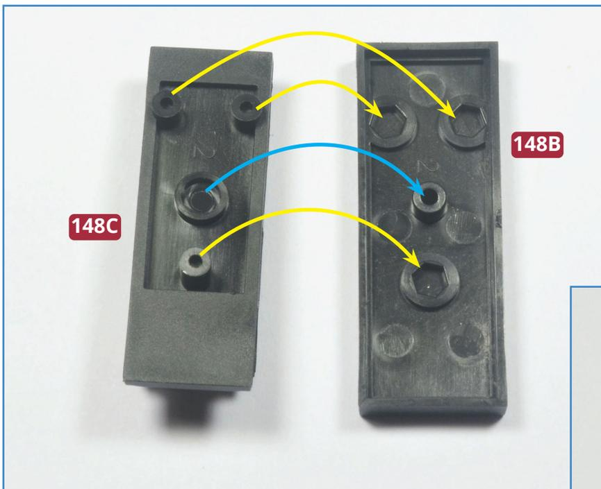
**3** Legen Sie die beiden Seitenverkleidungen **148B** und **148C** bereit. Fügen Sie die zwei Teile zusammen, indem Sie die drei Zapfen von **148C** in die Aufnahmen von **148B** einfügen (gelbe Pfeile). Das Schraubenloch von **148C** fluchtet mit der erhöhten Schraubenaufnahme von **148B** (blauer Pfeil). Befestigen Sie die Teile mit einer Schraube **RM** aneinander (unten).
