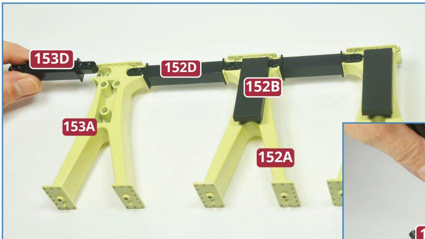
**2** Fügen Sie das mit einer „6“ markierte Ende des Verbindungsstegs **153D** in die freie Aufnahme der Säule **153A** ein (links). Fluchten die Schraubenlöcher beider Teile, fixieren Sie sie mit zwei Schrauben **RM** aneinander (unten).
