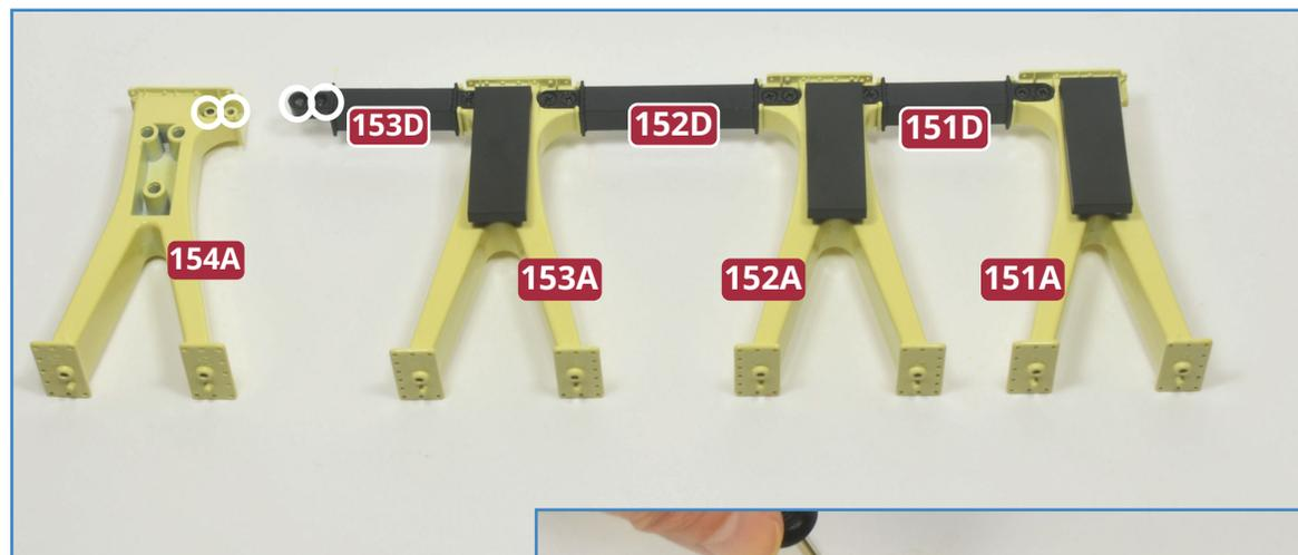
**1** Legen Sie die Zylinderbaugruppe bereit, die Sie mit der letzten Ausgabe weitergebaut haben. Fügen Sie die Säule **154A** so mit dem Verbindungssteg **153D** zusammen, dass Schraubenlöcher und Aufnahmen (beide oben weiß eingekreist) fluchten. Befestigen Sie den Verbindungssteg mit zwei Schrauben **RM** an der Säule (rechts weiß eingekreist).
