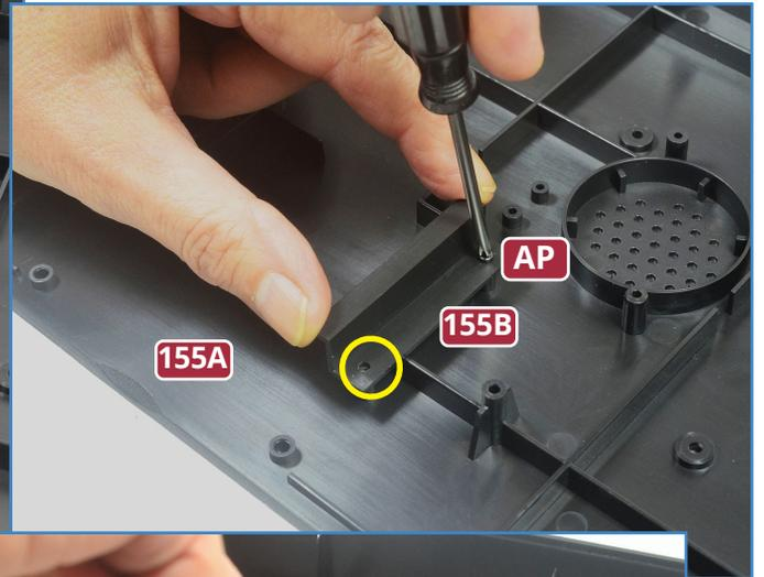
**2** Nehmen Sie den zweiten Halter **155B**, positionieren Sie ihn auf den entsprechenden Schraubenaufnahmen (oben) und befestigen Sie ihn ebenfalls mit zwei Schrauben **AP** (rechts und rechts oben).
