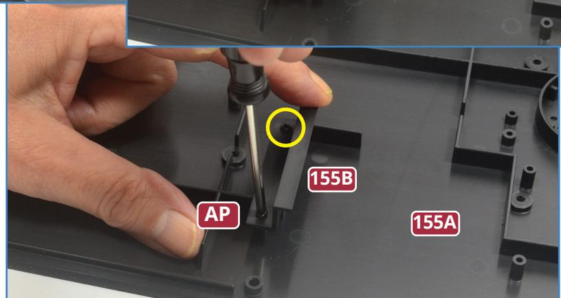
**1** Nehmen Sie die Basis der Maschine **155A** und legen Sie sie mit der Oberseite nach unten auf Ihre Arbeitsplatte. Identifizieren Sie die beiden Schraubenaufnahmen, an denen der erste Halter **155B** befestigt werden soll (oben, eingekreist). Positionieren Sie den Halter wie abgebildet und fixieren Sie ihn mit zwei Schrauben **AP** (rechts und rechts oben, gelb eingekreist).
