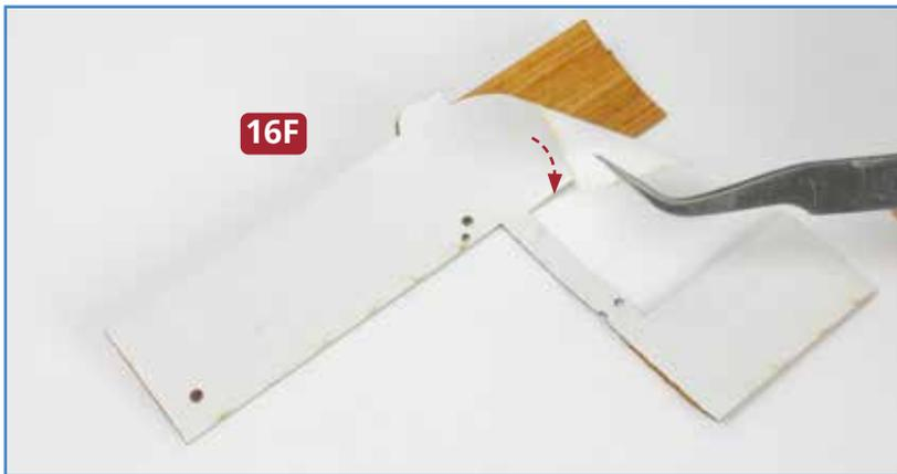
**1** Machen Sie zunächst eine provisorische Passprobe mit dem hölzernen Decksbelag **16F** auf der Aufbaustruktur **16E**. Ziehen Sie anschließend ganz vorsichtig die Schutzfolie vom Decksbelag ab (oben). Achten Sie beim Verlegen des Decksbelags auf der Aufbaustruktur darauf, dass alle Bohrungen beider Teile fluchten. Glätten Sie auftretende Unebenheiten sofort mit einem weichen Tuch. Drücken Sie die Kanten des Decksbelags fest an.
