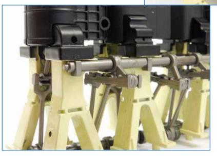
6 Richten Sie die Maschine so aus, dass das lange Ende der Kurbelwelle nach links weist (ganz oben, blau eingekreist). Platzieren Sie die Verbindungswellen-Baugruppe so vor der Maschine, dass die flache Seite ihrer Blöcke nun nach oben weist. Verbinden Sie die Haken der vier Ventilstangen 27G mit den ganz oben weiß eingekreisten Stellen der Kurbelwelle 29B.
