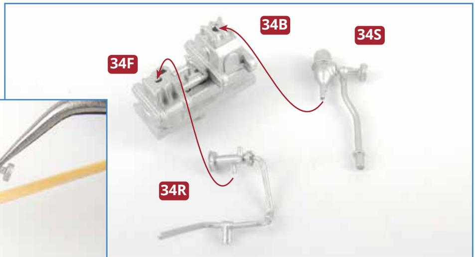
**3** Der Zapfen von Detail **34S** wird in der Bohrung des Teils **34B** von der großen Pumpe fixiert (oben). Anschließend wird der Zapfen des Verbinders **34R** in der äußeren Bohrung des Teils **34F** festgeklebt. Das Foto rechts zeigt die komplettierte Baugruppe.
